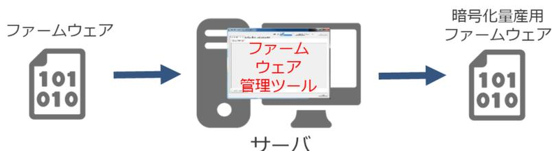
図 1-5 量産ファームウェア生成のシステム構成図
