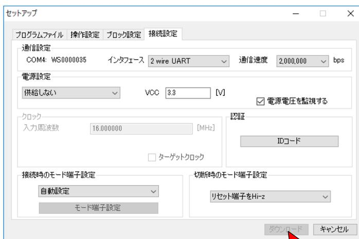
図 2-25 セットアップファイル生成の GUI イメージ
