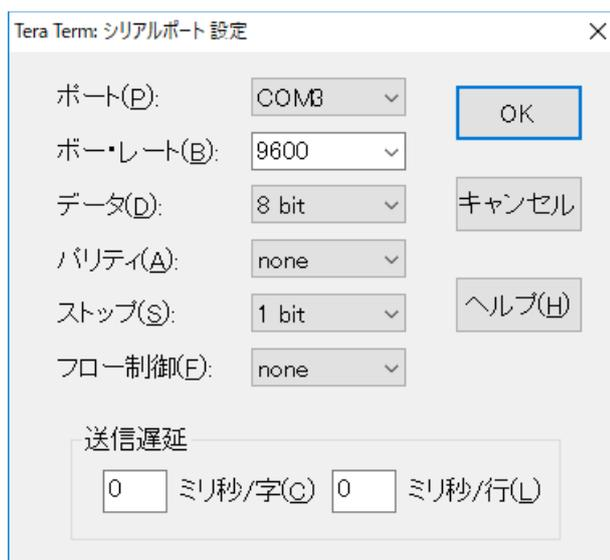
図 2-27 TeraTerm 通信設定の GUI イメージ
