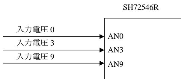
図 1 SH72546R による電圧の測定ブロック図
