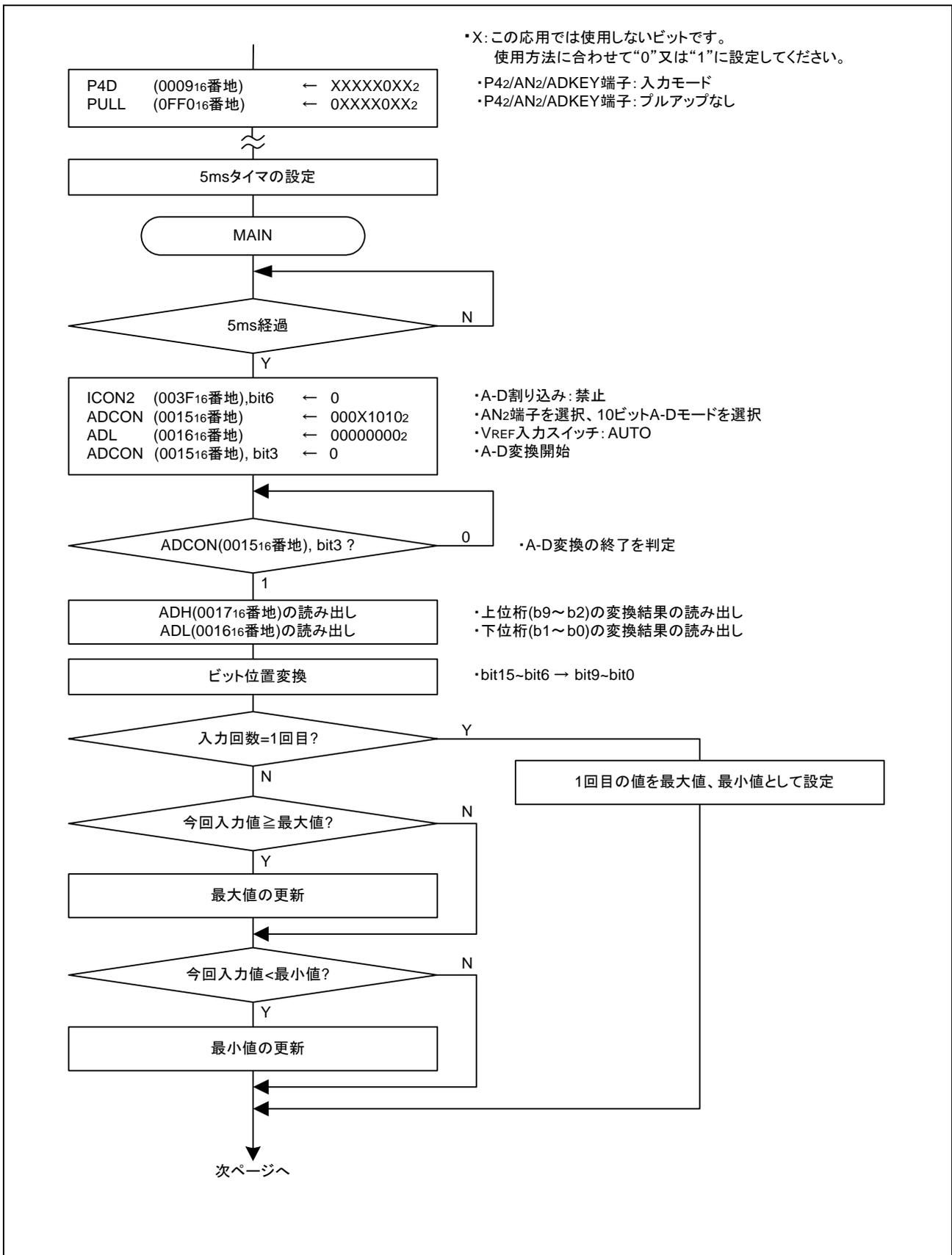
図 3.3 ADキー読み込みの制御手順(1)
