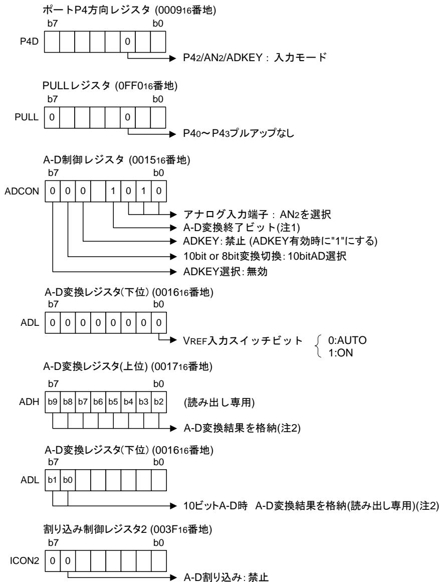
注1. A-D変換終了ビットを"0"にするとA-D変換を開始します。
