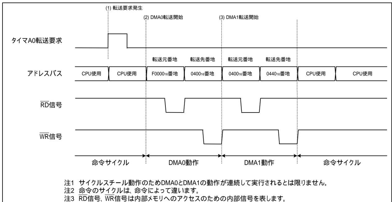
図 1 メモリからメモリへの DMA 転送タイミング
