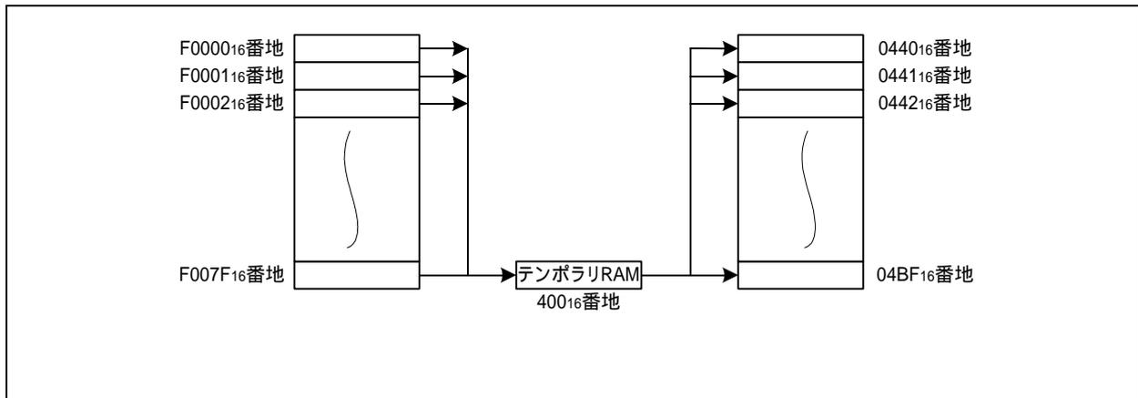
図 2 メモリからメモリへの DMA 転送のブロック図
