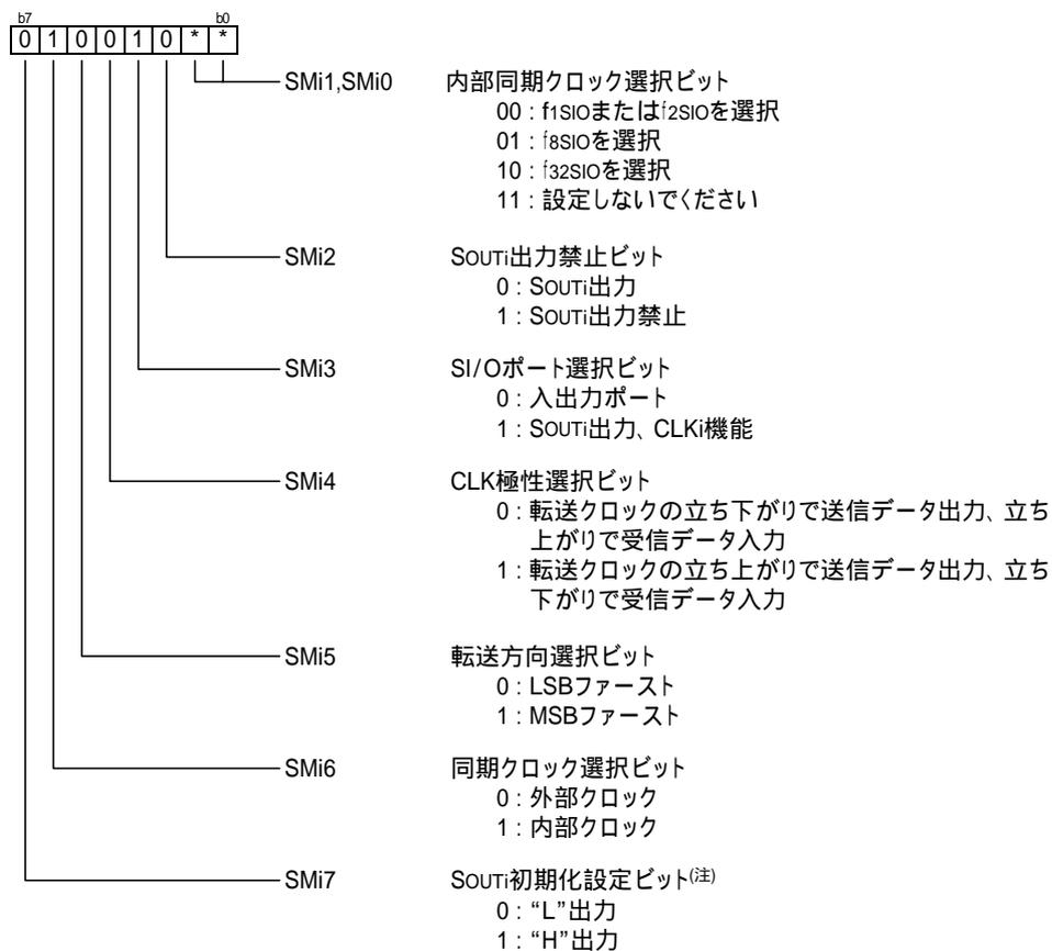
注. SI/Oiの初期値設定機能では、SMi7ビットを設定後、SMi3ビットを“1”にしたタイミングから、1バイトめのデータ出力開始までに出力するレベルを設定できます。
