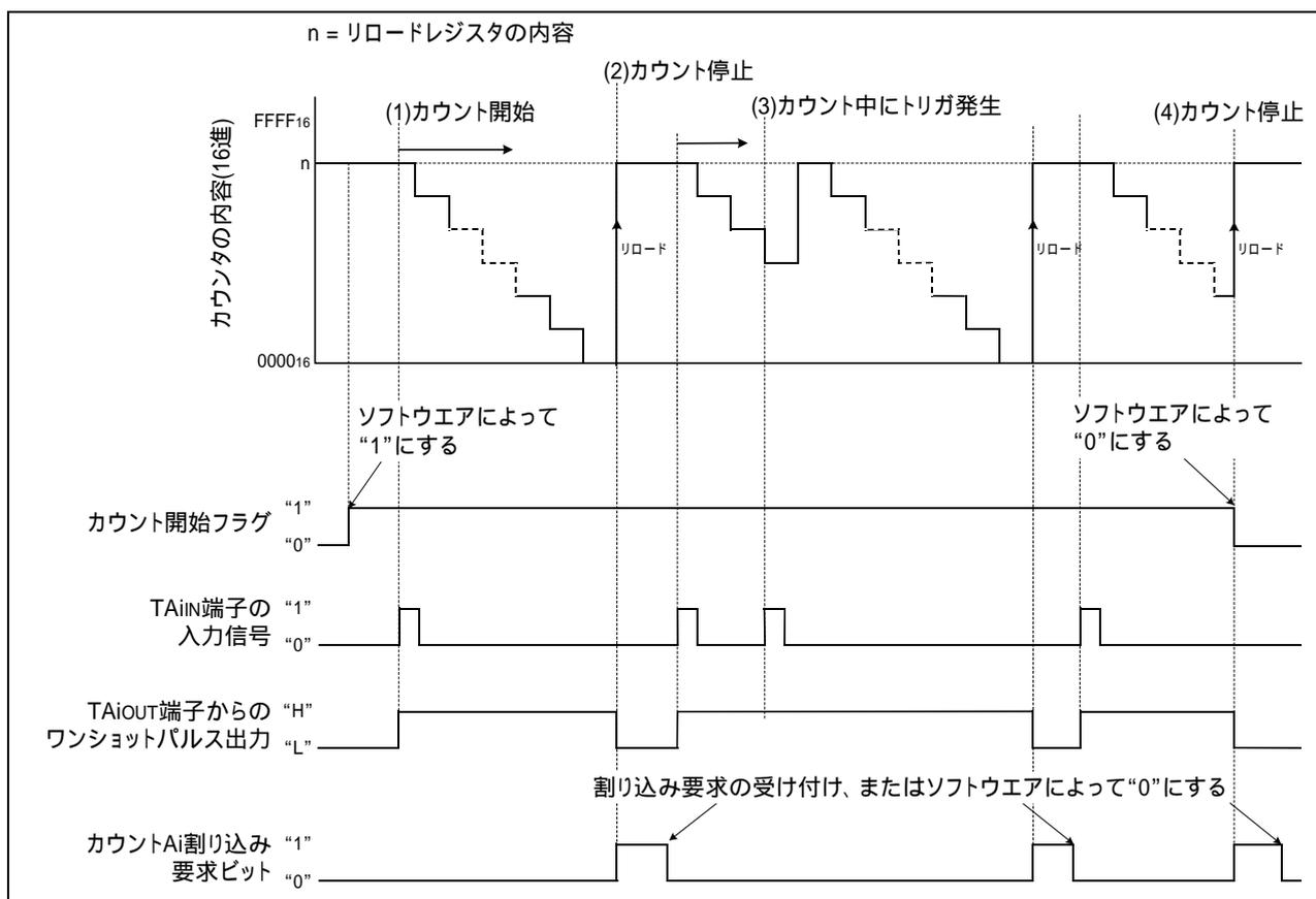
図 1 ワンショットタイマモード、外部トリガ選択時の動作タイミング
