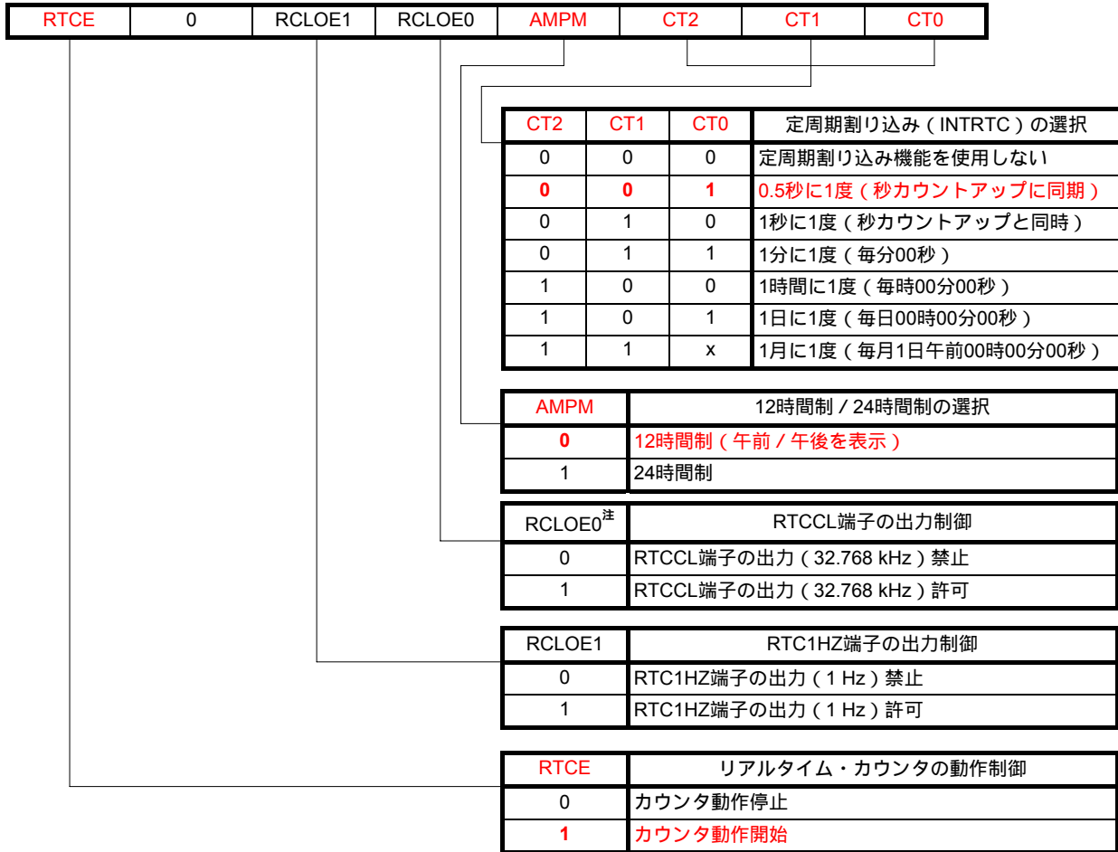
図4 - 2 リアルタイム・カウンタ・コントロール・レジスタ0 (RTCC0) のフォーマット
