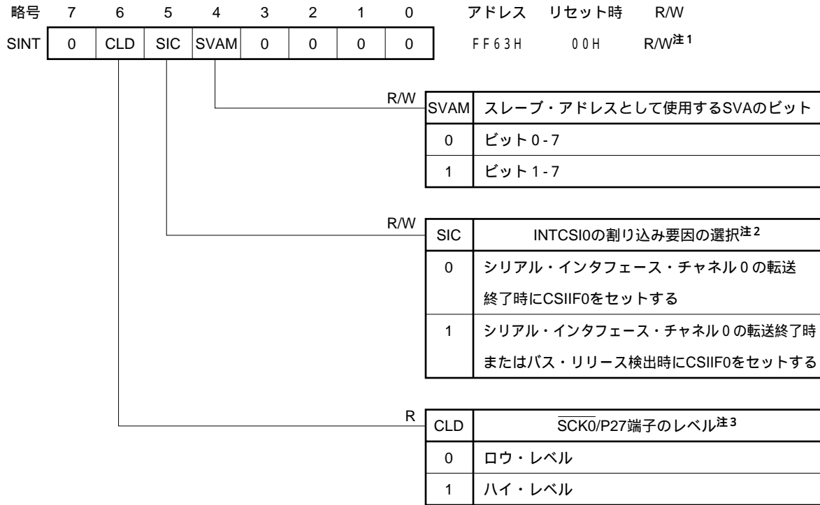
図8 - 10 割り込みタイミング指定レジスタのフォーマット ( μPD78054, 78064, 78078, 780058, 780308, 78058F, 78064B, 78075B, 78098Bサブシリーズ, μPD78070A )
