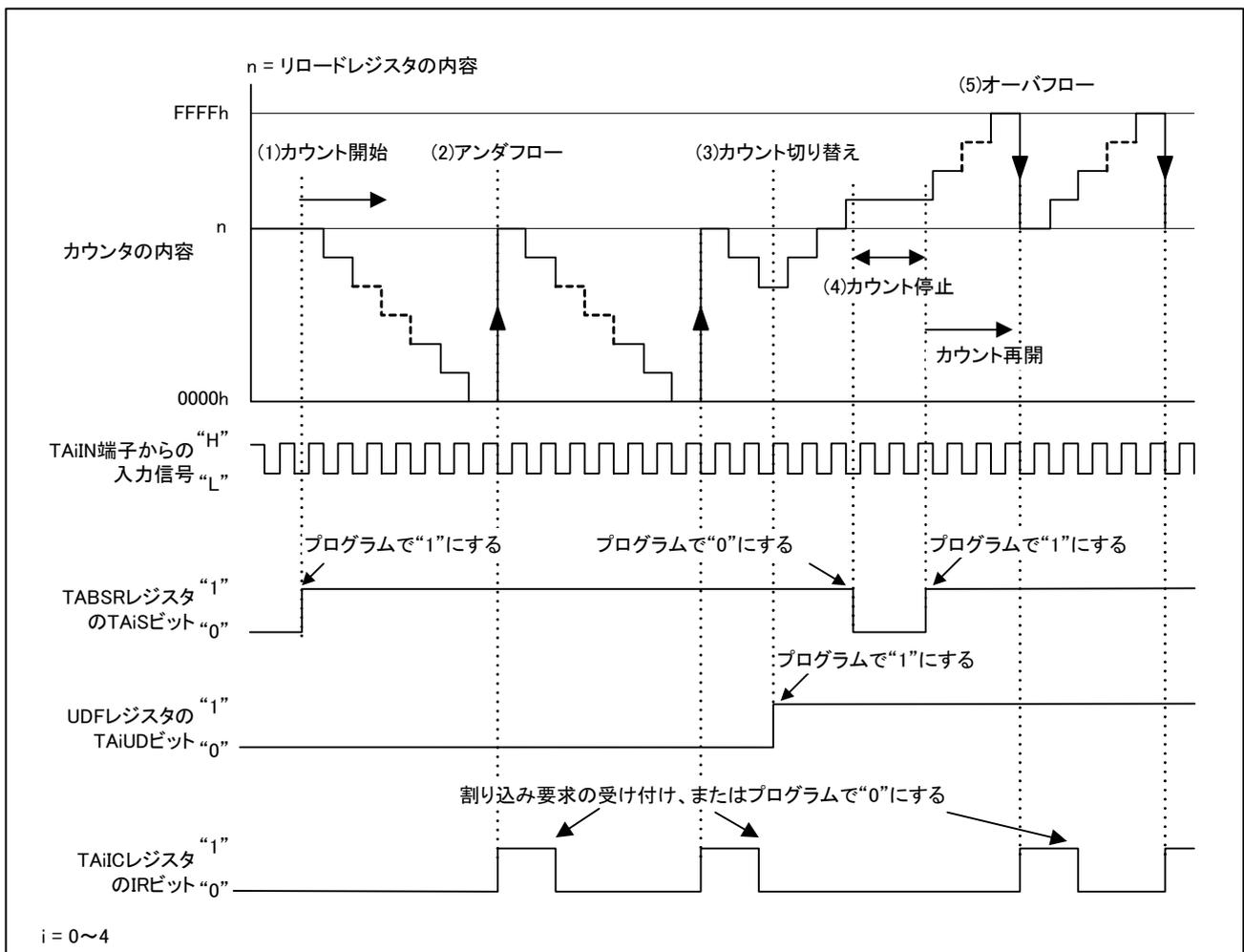
図 1. イベントカウンタモード、リロードタイプ選択時の動作
