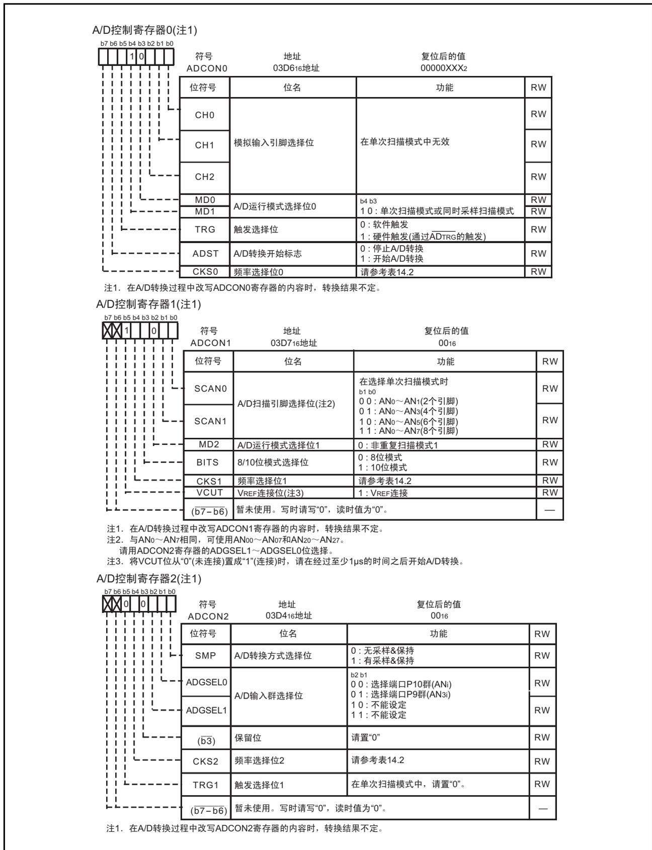
图 14.11 单次扫描模式中的 ADCON0 ~ ADCON2 寄存器
