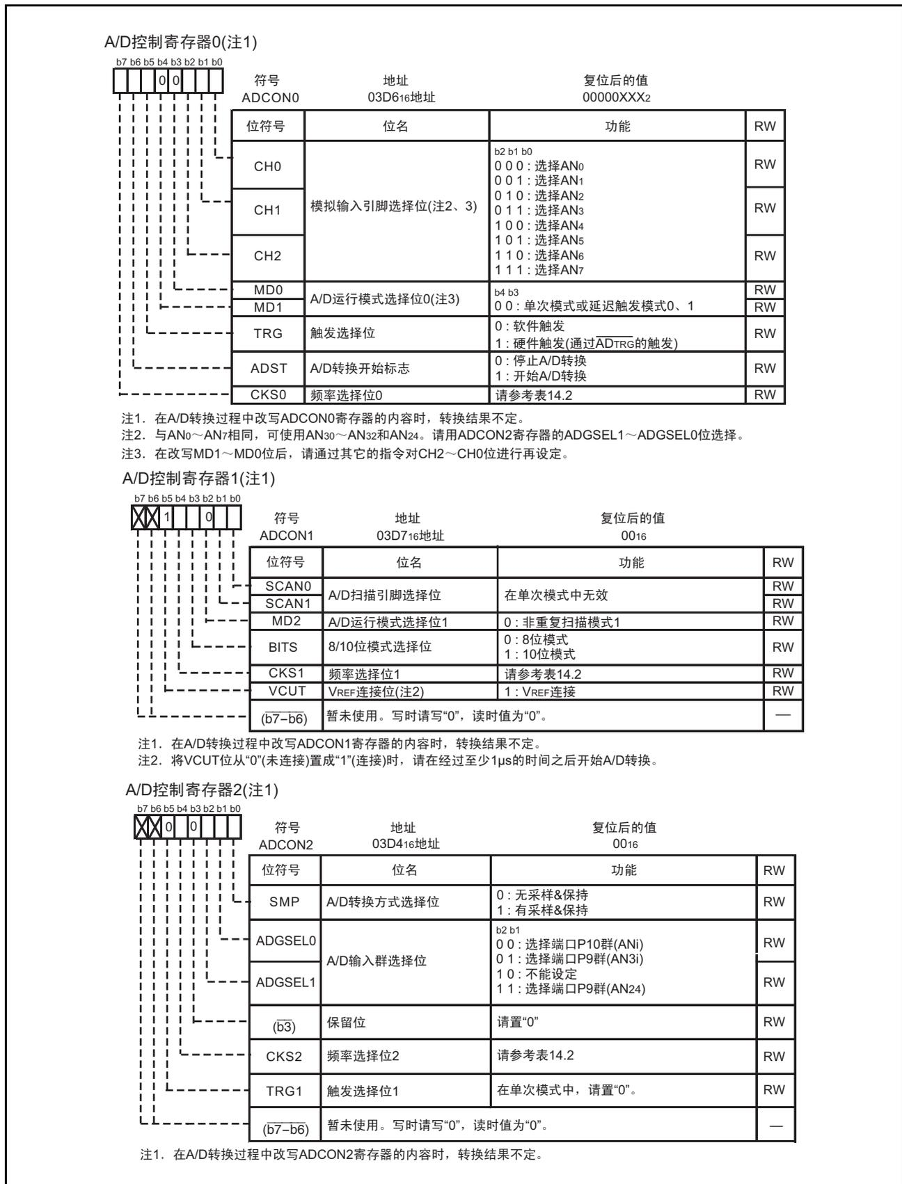
图 14.7 单次模式下的 ADCON0 ~ ADCON2 寄存器
