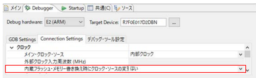
図3.10 [内蔵フラッシュ・メモリー書き換え時にクロック・ソースの変更]の設定
