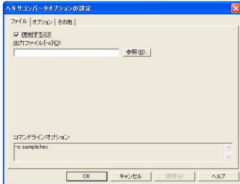
図7 - 2 [ヘキサコンバータオプションの設定]ダイアログ:[ファイル]タブ
