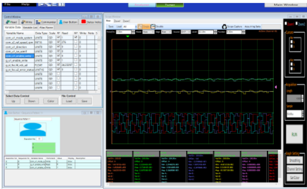
图 6-3: Motor Control Workbench 允许自动调整参数和监测运行系统
