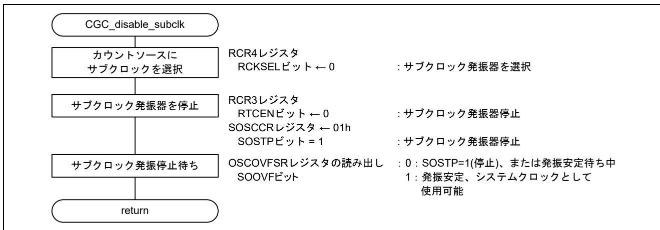
図 3.11 サブクロックの停止設定
