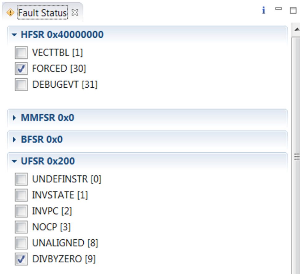
図 66: ゼロ除算によるハード障害が発生した場合の障害ステータスビュー
