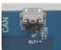
図 6. PE-HMI1 kit から PC へ接続する USB CDC コネクタの詳細
