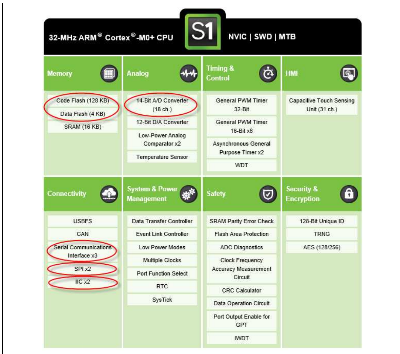
図 2.1 S1 OOB アプリケーションが使う S124 ハードウェア周辺回路
