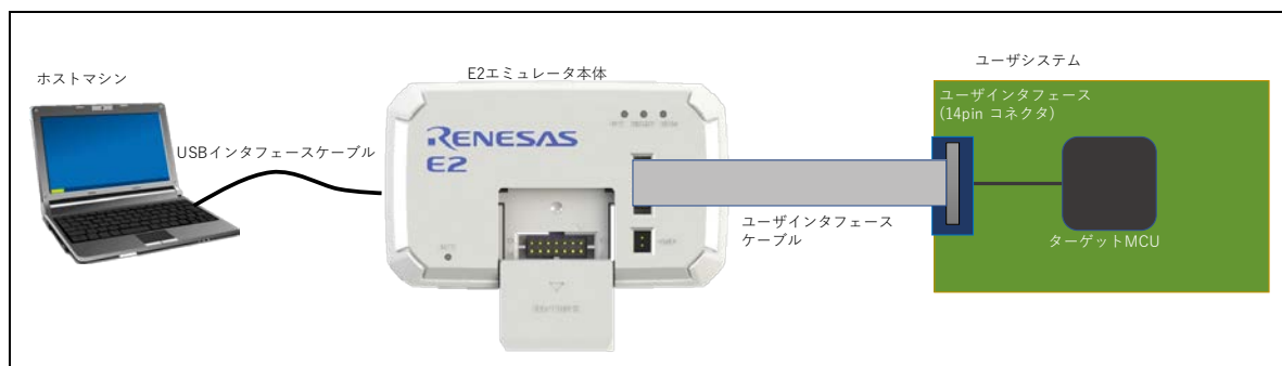
図 3-2 システム構成例 1
