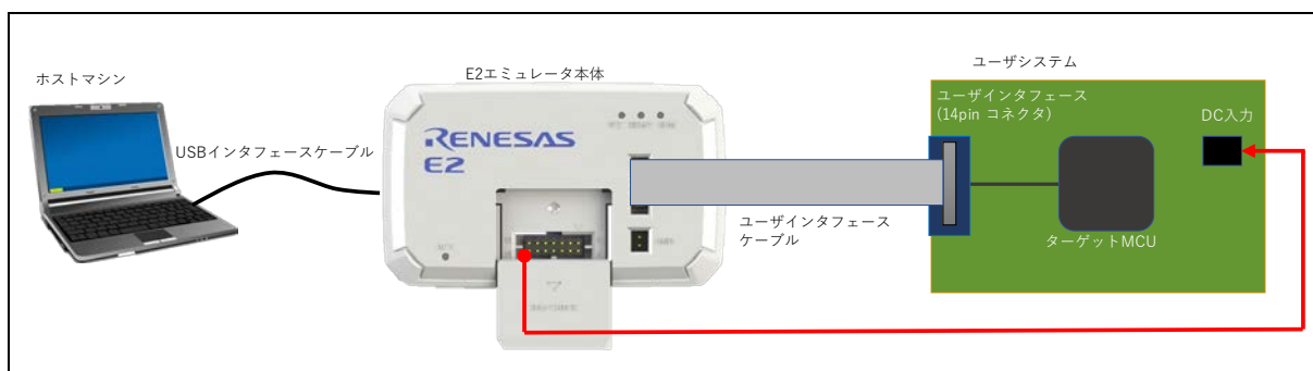
図 3-3 システム構成例 2
