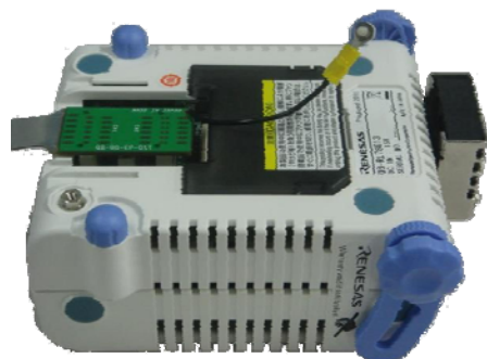
図2-4 エミュレーション・プローブの接続方法
