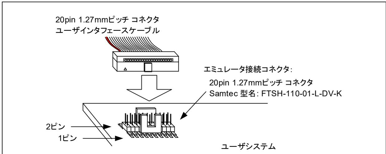
図2-1 20ピンコネクタへの接続方法
