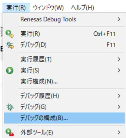
図3-18 デバッグ構成へのアクセス方法
