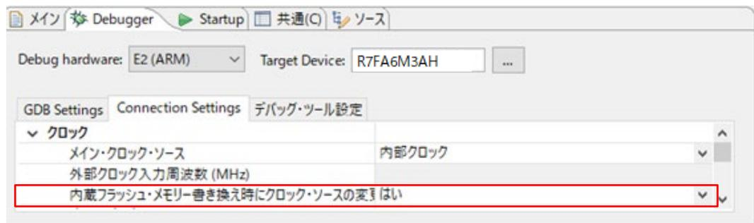
図3-8 [内蔵フラッシュ・メモリー書き換え時にクロック・ソースの変更]の設定
