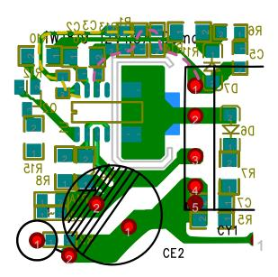
Figure 10.10a : V<sub>SENSE</sub> Feedback Path
