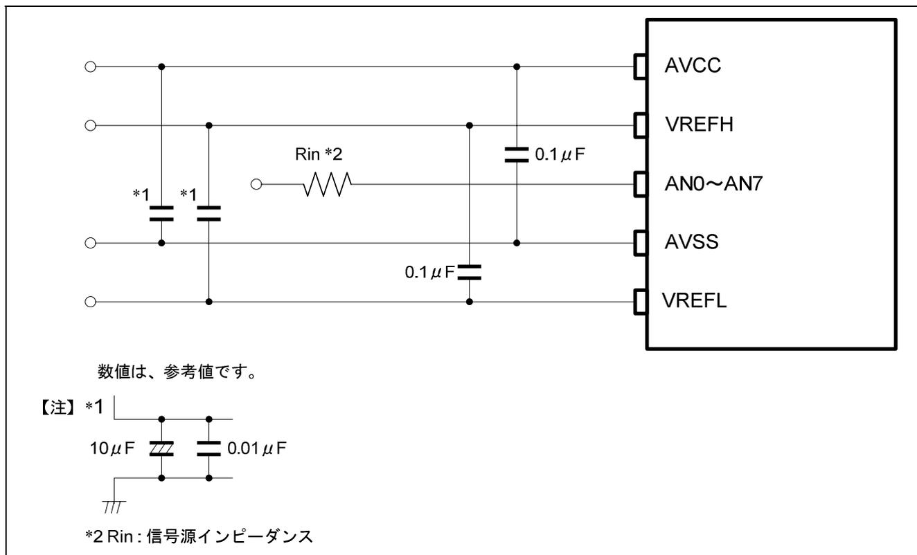
図 4 電源ラインのノイズ対策
