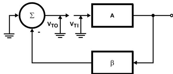
FIGURE 2. BLOCK DIAGRAM FOR COMPUTING THE LOOP GAIN
