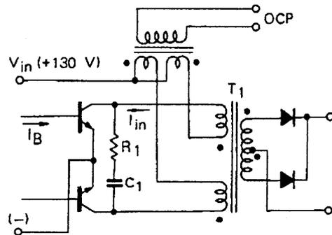
$R_1, C_1$ : Surge Absorption Circuit
